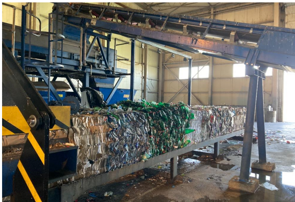
Slika 4.4. Presovani materijal – bale
