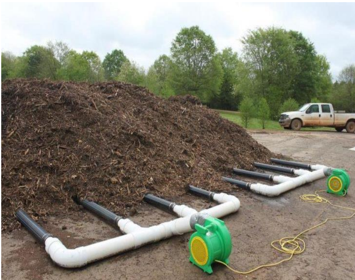
Slika 2.2. Kompostiranje u vrsti sa aktivnom aeracijom (Izvor: https://www.trustbasket.com/blogs/composting/aerobic-composting )
